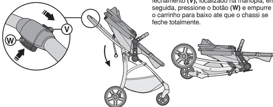
Deslize para esquerda e segure botão de fechamento (V), localizada na manopla, em seguida, pressione o botão (W) e empurre o carrinho para baixo até que o chassi se feche totalmente.
