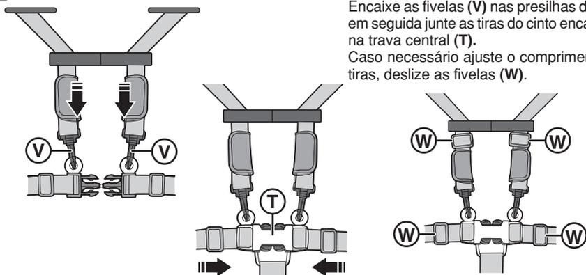
Encaixe as fivelas (V) nas presilhas do cinto, em seguida junte as tiras do cinto encaixando na trava central (T).
